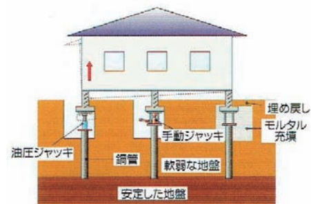
支持杭圧入工法
